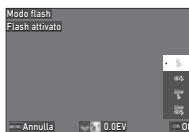
**Flash automatico** Misura automaticamente la luce ambiente e determina se usare il flash.
