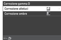
È possibile ridurre l'evenienza di aree sovraesposte/sottoesposte espandendo la gamma dinamica e consentendo la registrazione di una più ampia gamma di toni da parte del sensore CMOS.
